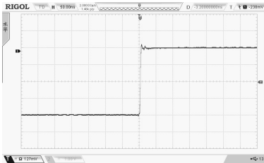
图 3 未添加输入延长线的波形
